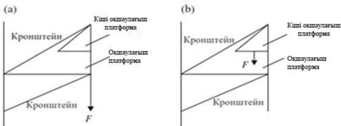
6.17-сурет. Окшаулағыш платформаны статикалық және динамикалық жүктемеге сынаудың сұлбалық бейнесі (a) окшаулағыш платформаны көтеру қабілеттілігі үшін сынау; b) кіші окшаулағыш платформаны көтеру қабілеті үшін сынау.
