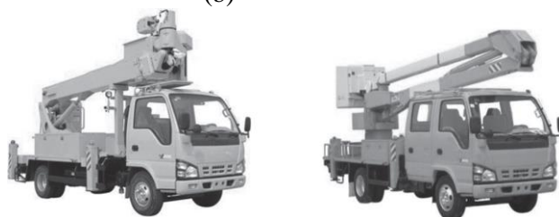
6.1-сурет. Оқшаулағыш буындарымен жабдықталған көтергіш құралдары. (a) тік жебе; (b) жиналатын жебе.
