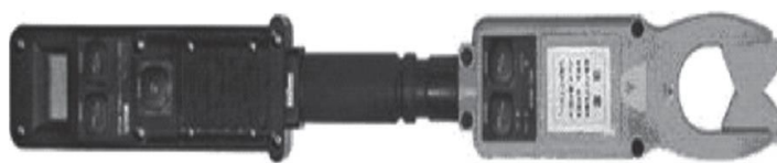
4.10--сурет. амперметрдегі сандық қысқыш. (а) кәдімгі тип; (Б) оқшаулағыш тип.
