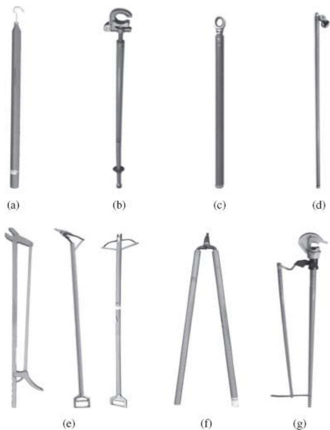
4.1--сурет. Үлгілік оқшаулаушы қол қарнақтар (штанга) (a) Оқшаулаушы қарнақ (штанга); (b) сымға арналған оқшаулаушы ілгек; (c) оқшауланған сомын кілті; (d) оқшаулаушы виндер; (e) оқшауланған қысқыш; (f) сымға арналған оқшауланған кескі; (g) оқшауланған гидравликалық кескі.
