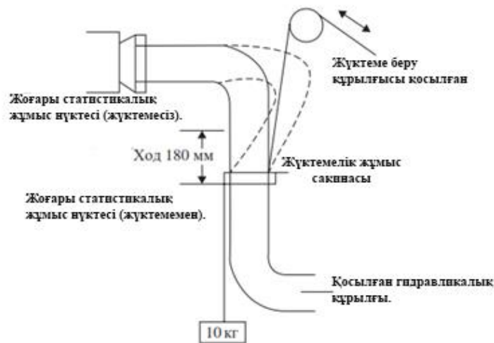
6.13--сурет. Бүгілуде қысымды жасаумен резеңке гильза сынауының циклы.
