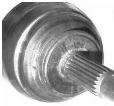
Рисунок 9.1. Внешний вид карданного вала и CV корпуса (переднее колесо), соединенных дуговой сваркой
