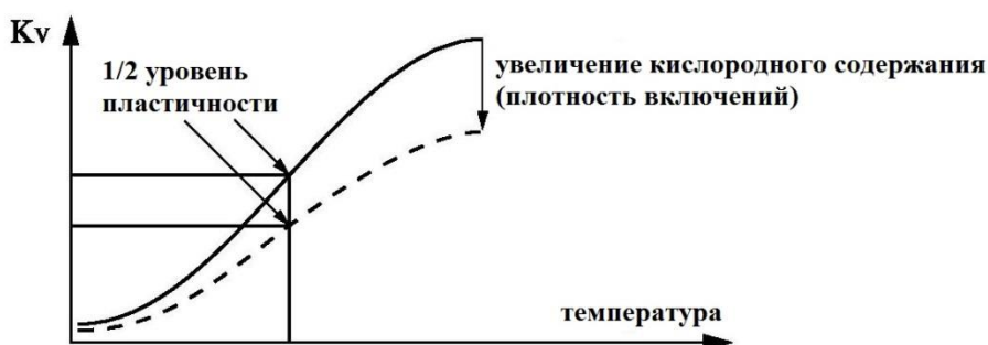
Рисунок 4.10. Влияние содержания кислорода на переходную кривую Шарпи-V
