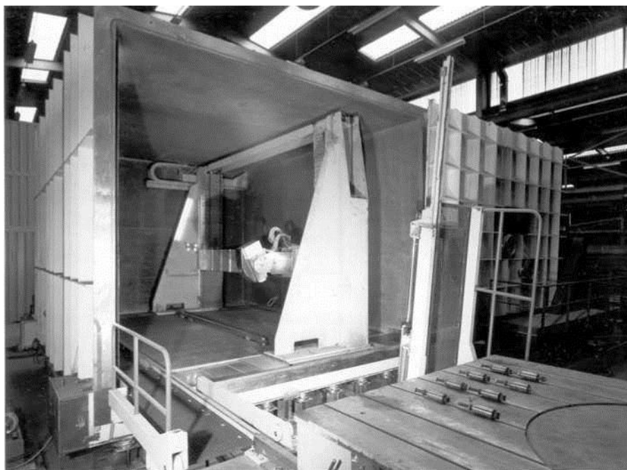
Рисунок 2.20. 50 кВт ЭЛС станок с внутренней пушкой, размеры 8х5х5м (документ Techmeta)
