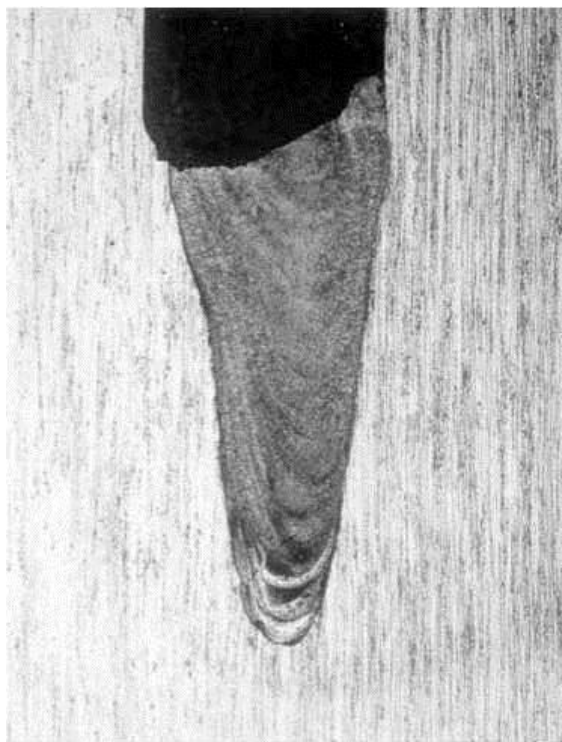
Рисунок 2.31. 2 мм-вая глубина проникновения в алюминиевом сплаве 7020, сваренном электронным лучом (документ Institut de Soudure)
