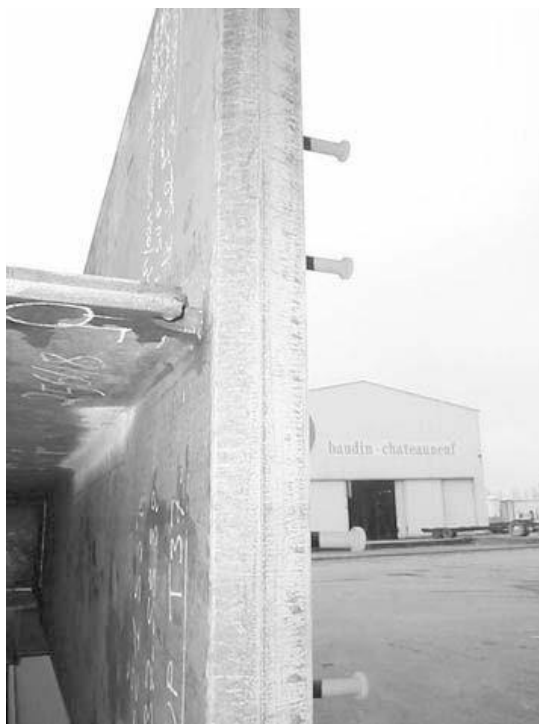
Рисунок 10.9. Мостовая балка с подготовкой двойной V-образной кромки - фотоснимок из Боден-Шатонёф
