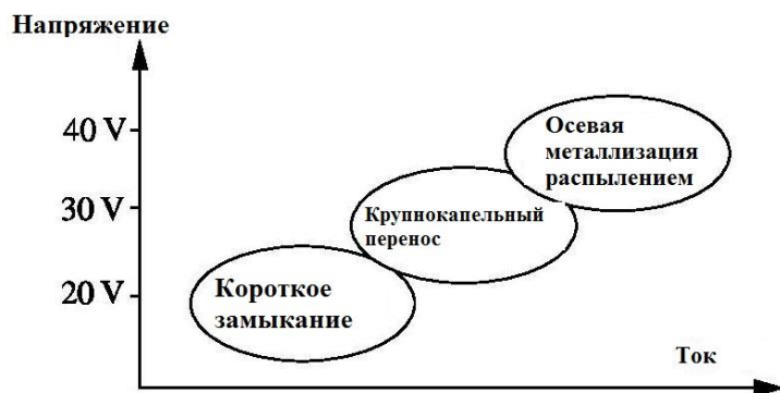
Рисунок 8.24. Типы переноса в дуговой сварке плавящимся электродом
