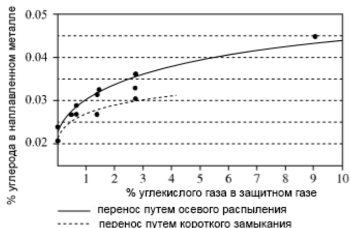
Рисунок 5.17. Влияние содержания \text{CO}_2 в защитном газе на процентное содержание углерода в наплавленном металле в зависимости от режима переноса (проволока ER308LSi с \text{C} = 0,18\% )
