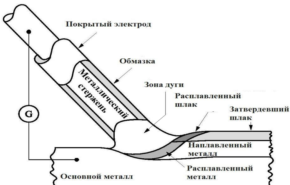
Рис.1.7. Дуговая сварка с покрытым электродом
