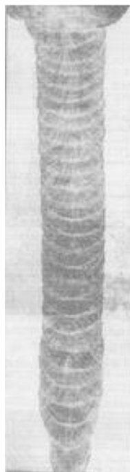
Рисунок 11.10. Макрографический профиль узкой скошенной кромки вольфрамовой сварки, выполненной в положении 5GT
