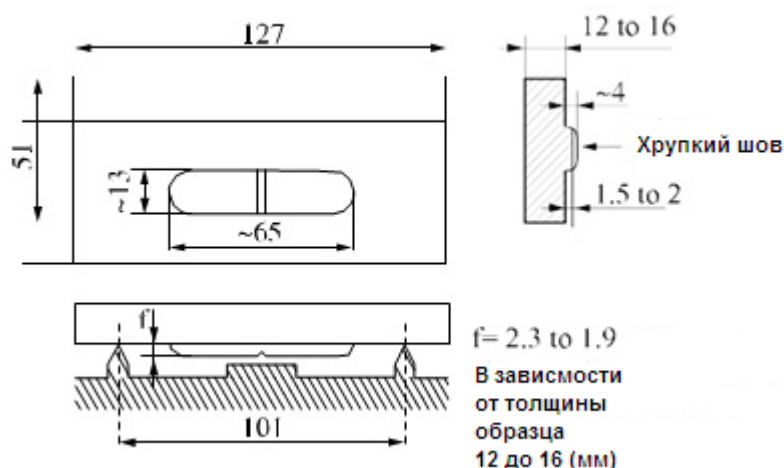
Рисунок 7.4. Размеры образца Пеллини; от [LEI 71]
