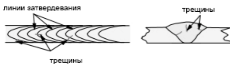
Рисунок 4.12. Локализация усадочных трещин
