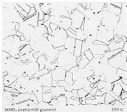
Рисунок 12.5. Структура аустенита AISI 304 EN 1.4301
