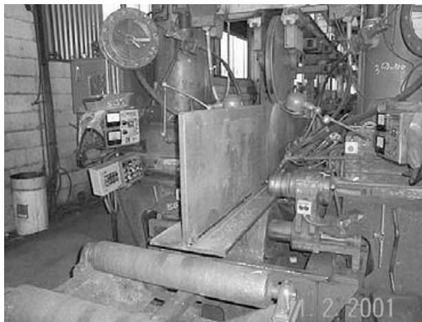
Рисунок 10.4. Строительство I секции на вертикально стенде, фотоснимок из Baudin-
