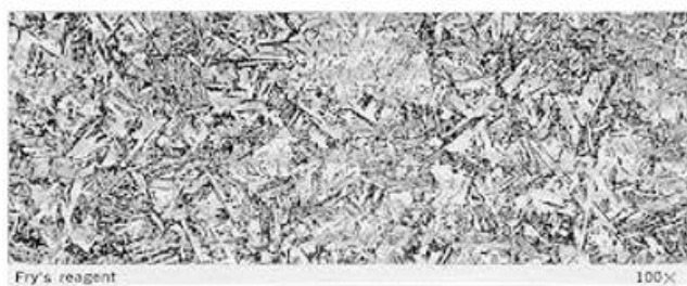
Рисунок 12.7. Структура мартенсита AISI 630 EN 1.4542
