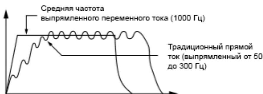
Рисунок 8.7. Волновые диаграммы традиционного постоянного и среднечастотного выпрямленного переменного тока
