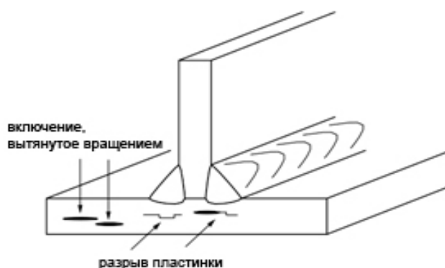
Рисунок 3.18. Растрескивание как следствие расслаивания
