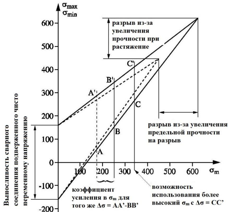
Рисунок 6.23. Увеличение усталостной прочности, подверженной волнообразным нагрузкам, за счет использования стали с более высокими эксплуатационными характеристиками; из [COL 82]
