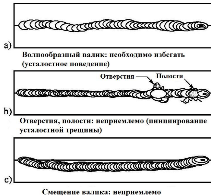
Рисунок 9.14. Возникновение усталостной трещины
