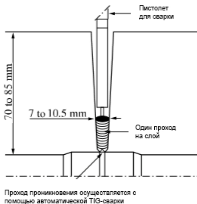
Рисунок 11.9. Принцип подготовки узкой скошенной кромки для орбитальной дуговой сварки вольфрамовым электродом в среде инертного газа
