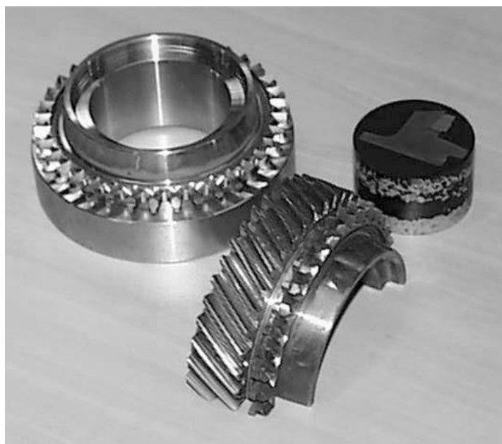
Рисунок 9.3. Изображение кулачковой муфты, приваренной к шестерне, с нарезанными зубчиками или без них.
