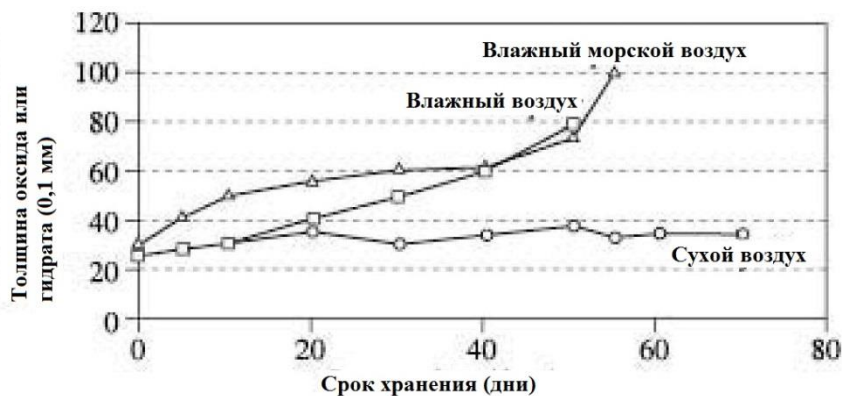
Рисунок 13.11. Изменение толщины оксидного слоя в зависимости от условий хранения
