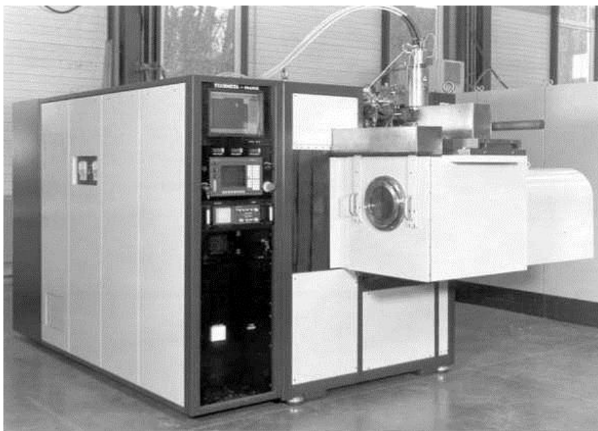
Рисунок 2.19. 6 кВт ЭЛС станок, размеры 0,6 м × 0,6 м × 0,9 м (документ Techmeta)
